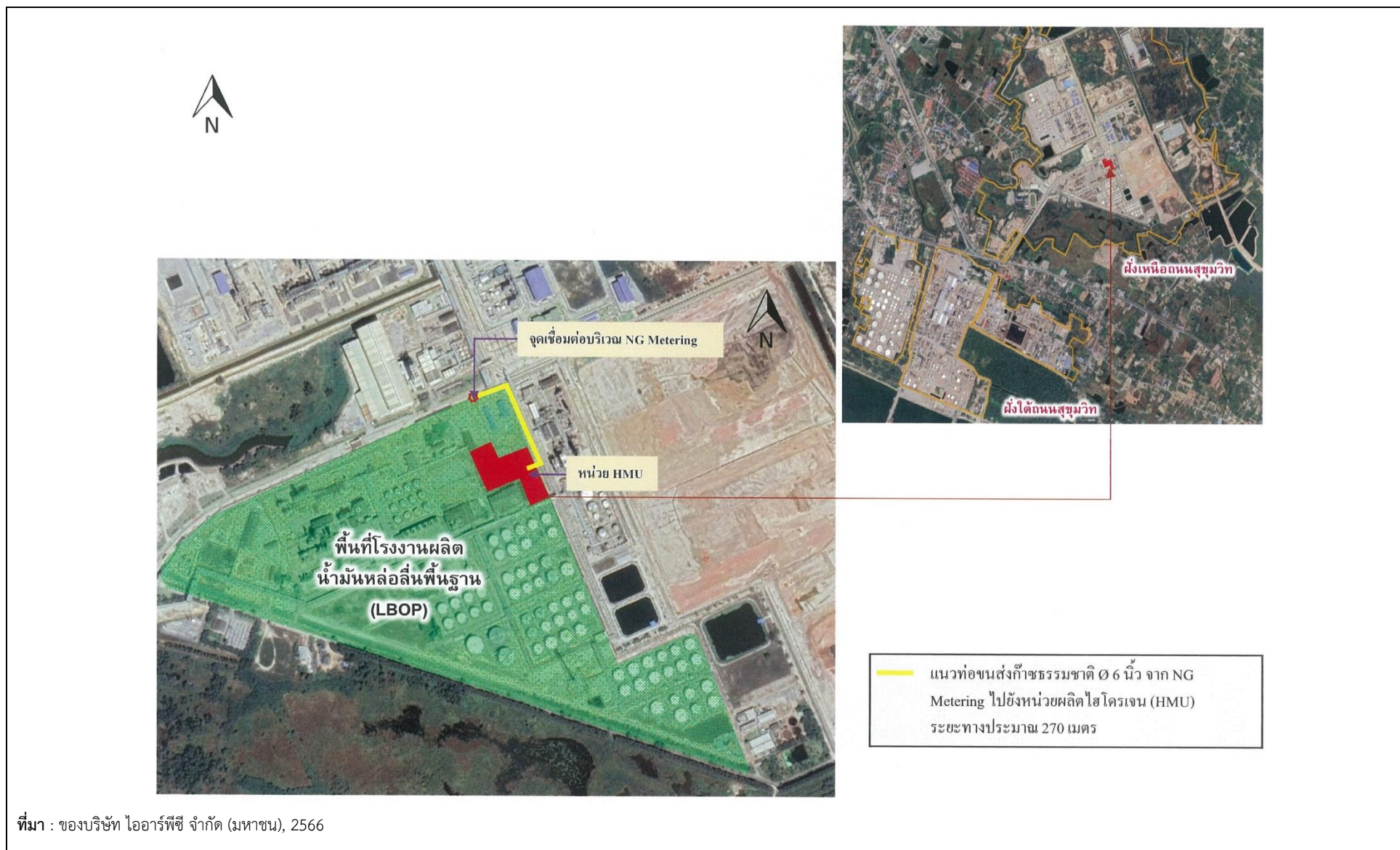
รูปที่ 1.2-2 แนวท่อจากสถานีตรวจวัดปริมาตรก๊าซ (NG Metering) ไปยังหน่วยผลิตไฮโดรเจน (HMU)
